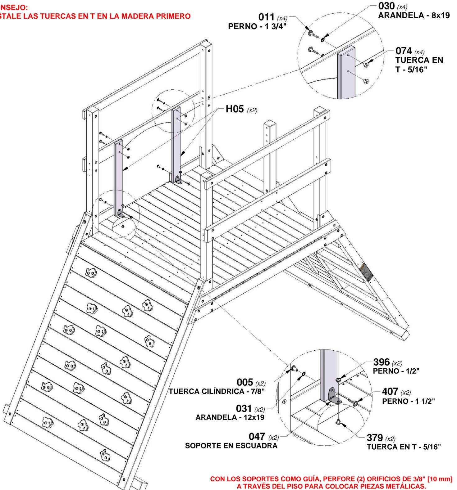
**CON LOS SOPORTES COMO GUÍA, PERFORE (2) ORIFICIOS DE 3/8" [10 mm] A TRAVÉS DEL PISO PARA COLOCAR PIEZAS METÁLICAS.**
