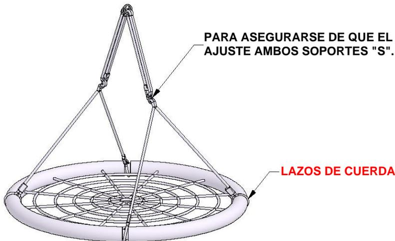
**UNA VEZ QUE ESTÉ INSTALADO, EL COLUMPIO DEBE QUEDAR A UNA DISTANCIA MÍNIMA DE 8 PULGADAS POR ENCIMA DEL SUELO.**
