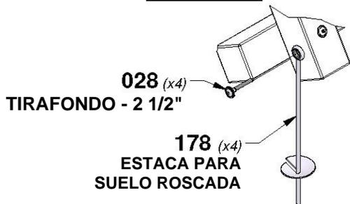
**GIRE LAS ESTACAS PARA INSERTARLAS EN EL SUELO EN LAS UBICACIONES INDICADAS. CON LA ESTACA COMO GUÍA, PERFORE UN ORIFICIO GUÍA DE 3/16" [5 mm] PARA EL TIRAFONDO.**
