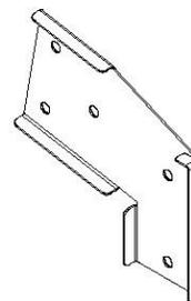
**A4M00618** | SOPORTE DE EXTENSIÓN DE VIGA DEL COLUMPIO - DERECHA
