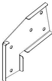
**A4M00617** | SOPORTE DE EXTENSIÓN DE LA VIGA DEL COLUMPIO - IZQUIERDA
