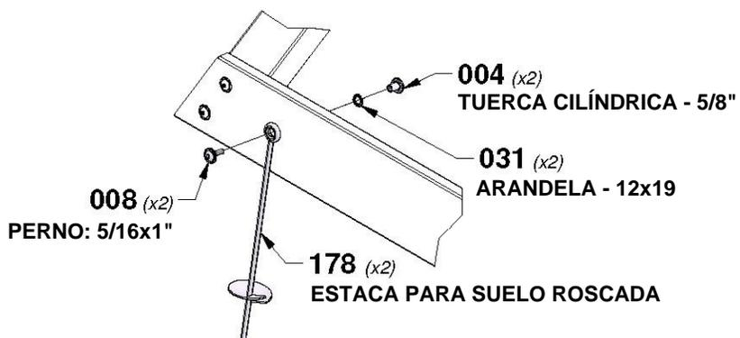
**GIRE LAS ESTACAS PARA INSERTARLAS EN EL SUELO EN LAS UBICACIONES INDICADAS. UTILIZANDO LAS ESTACAS COMO GUÍA, PERFORE UN ORIFICIO DE 7/16" [10 mm] PARA COLOCAR LAS PIEZAS METÁLICAS.**
